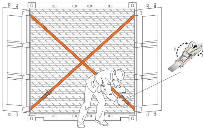
Ослабить ремни при помощи трещотки. Параллельно удалить материал, который использовался для защиты продукции.
