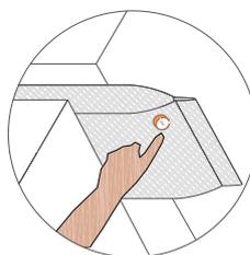
Вариант 1. Стравить воздух, нажав на встроенный в клапан пружинный механизм, и закрепить его в открытом положении. Вытащить пневмооболочку из контейнера.
