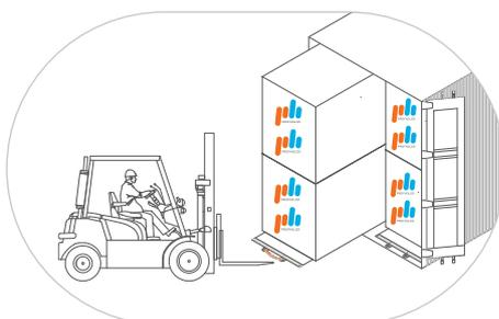
С помощью грузоподъемной техники вытянуть из контейнера пачки сэндвич-панелей за металлические листы со специальными креплениями. Вытягивать по одному листу, соблюдая технику безопасности. Из фуры пачки сэндвич-панелей необходимо выгружать двумя погрузчиками. Если контейнер стоит на земле, допустимо выгружать одним погрузчиком.
